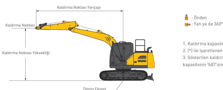
1. Kaldırma kapasitesi ISO10567:2007 ile uyumludur.
